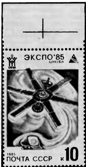
Контрольные метки на листовом поле для проверки совмещения красок
